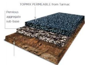
Coupe schématique des différentes couches : béton, gravats, sol
